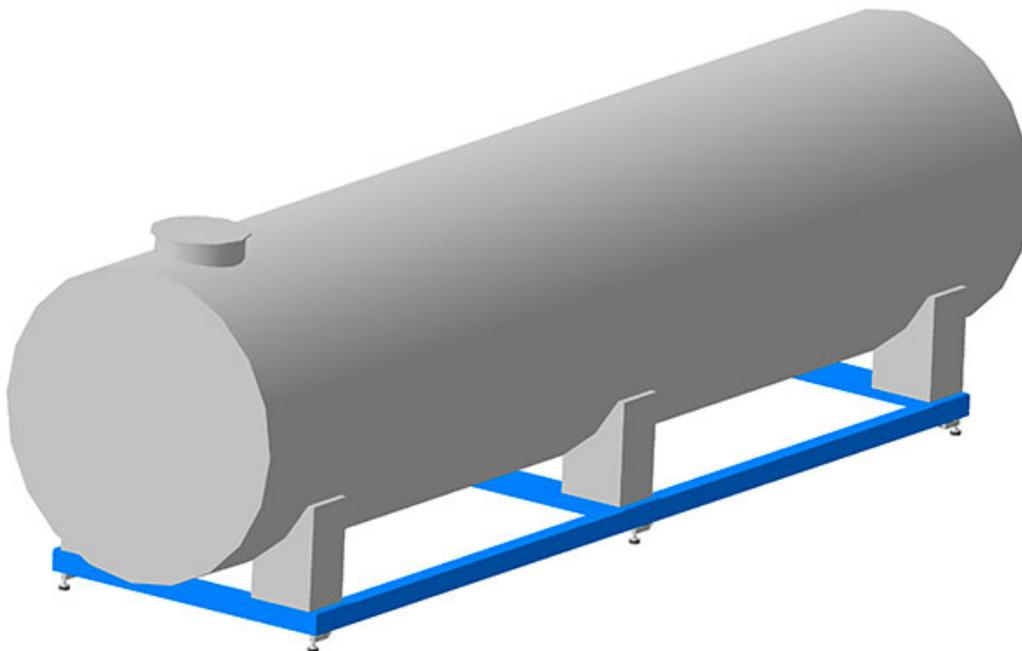
Весы предназначены для коммерческого учета жидких продуктов находящихся в емкости-охладителе. Небольшая высота весов обеспечивает легкость установки емкости на платформу. Система взвешивания танка-охладителя состоит из весовой платформы, установленной на 4 или 6 тензометрических датчика веса и весового терминала. Применяются разборные и неразборные весовые платформы.
