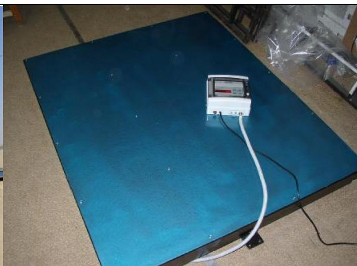
Г) Вариант установки весов платформенных ВСЭ-1000
