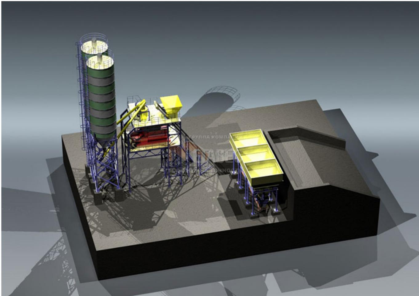
Модульный (быстромонтируемый) бетонный завод предназначен для производства бетона и строительных смесей. Бетонный завод состоит из весовых дозаторов (инертных, цемента, воды, добавок), магистрального транспортера или скипового подъемника, складов цемента, смесителя, электронной системы управления, аппаратной и навесного оборудования.
