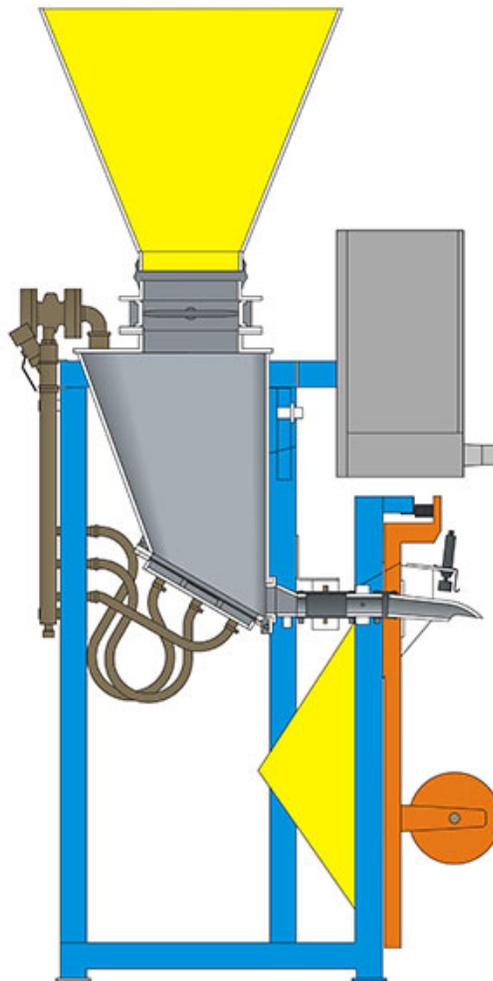
Принцип действия установки основан на принудительной подачи легких сыпучих материалов в клапанный мешок под давлением, создаваемым в донном выгрузителе с помощью сжатого воздуха. Дозирование продукта осуществляется при помощи тензодатчика, на котором расположен узел фасовки.
